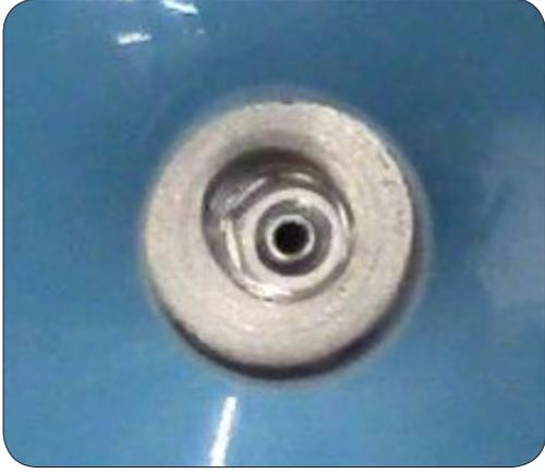
6. Con un encaje de 7 mm, instale la tuerca de la conexión One en el perno de brida. Apriete a 25 libras pulgadas.
