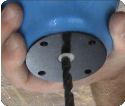
16. Introduce el filtro Poron en el orificio. Córtele al ras del encaje.
