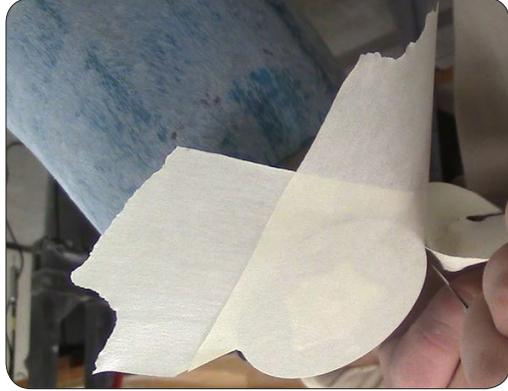
3. Fije el adaptador de 4 orificios con 4 piezas de carbón de 2,5 cm (1 pulg.) de ancho.
