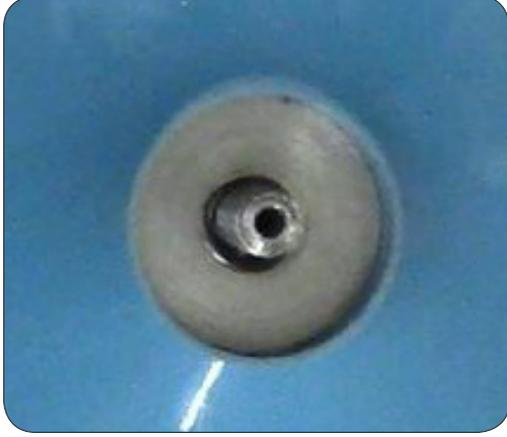
3. Con un encaje de 7 mm, instale la tuerca de la conexión One en el perno de brida.
